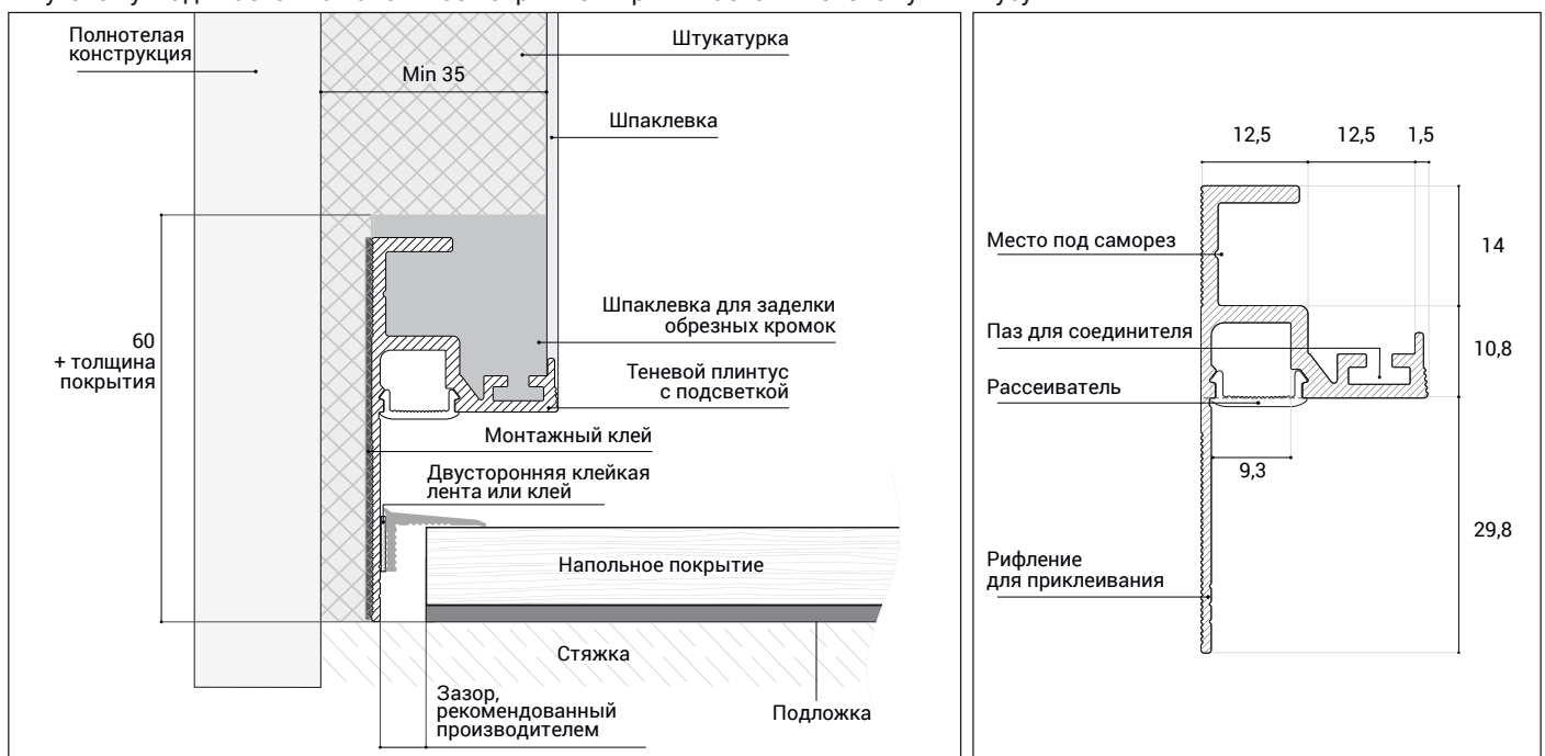
Пример монтажа. Вертикальный разрез. Узел стена – пол
