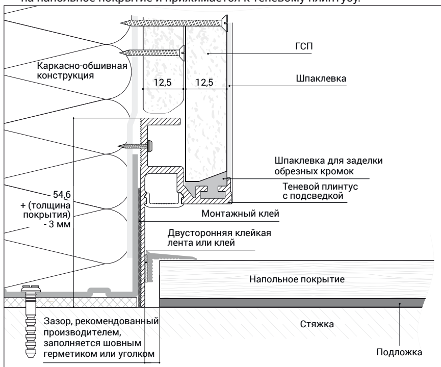
Пример монтажа. Вертикальный разрез. Узел стена – пол
