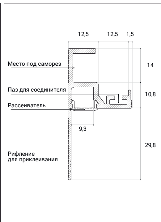
Сечение теневого плинтуса KRAAB GIPPS с рас-ем
